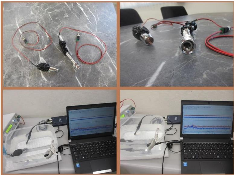
鉄めっき処理部品を利用した超音波プローブ
