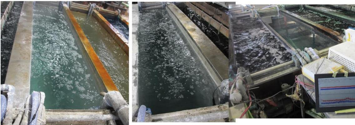
エアレーションとファインバブル(液循環)と超音波の最適化技術
